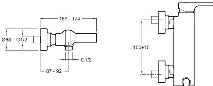
Спецификация продукта: Настенный смеситель для душа. E10869. Коллекция: SINGULIER. ВЕС: 3,1 кг. ТИП УСТАНОВКИ: Крепление к стене. ТИП: Однорычажный. РАСХОД ВОДЫ: 13 л/мин при давлении 3 бар. ПОДКЛЮЧЕНИЕ: С настенными крепежами и кольцами. МЕХАНИЗМ: Последовательный керамический картридж. РАЗМЕТКА ОТВЕРСТИЙ: 150 ± 15 мм. СЛИВ: 0. ОДНОРЫЧАЖНЫЙ СМЕСИТЕЛЬ: 0. УСТАНОВКА: 2 отверстия. ГАРАНТИЯ НА ОТДЕЛКУ: 10 лет.
